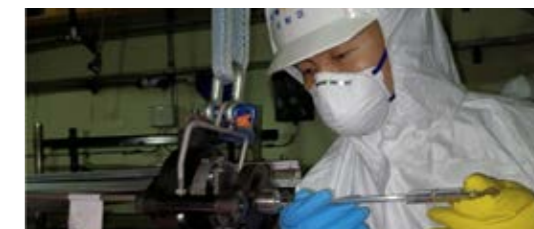
→ 指套管切割前的尺寸测量
